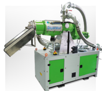
SEPARATOR PLUG & PLAY Sistema per separazione liquame mobile
