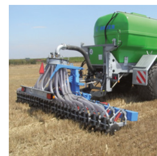
Iniettore a dischi Tecnica di spargimento innovativa
