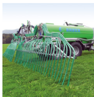
Sistema con flessibile trainato Sistema modulare per tutti i tipi di autocisterna
